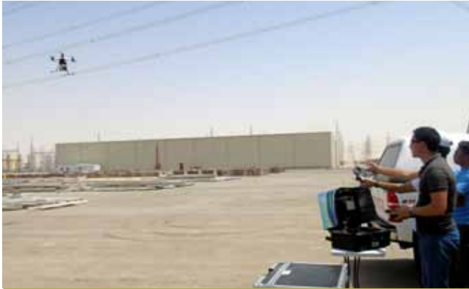
استخدام الطائرة اللاسلكية في عملية فحص الخطوط الهوائية
